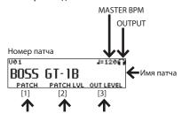
Параметры, которыми можно управлять с помощью регуляторов [1] — [3].
